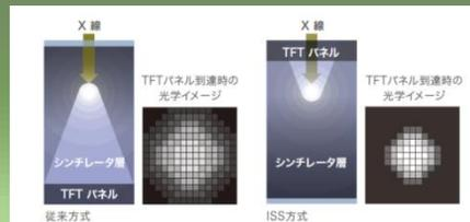
●従来型のFPDとは反対側のX線照射面側に光センサ (TFT) を圧着した「ISS方式」を採用。X線信号の散乱・減衰を大幅に抑制した高画質な画像を実現。
